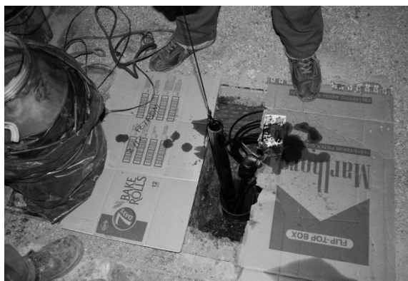
Fig.8 Recoltare hidrocarburi în stare liberă
