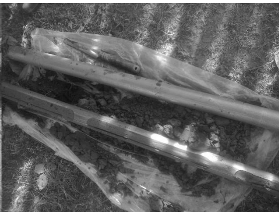
Fig.5 Sapa foraj tubular cu fereastră
