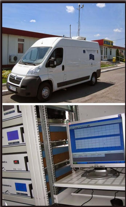
Figura 1: Laborator mobil pentru determinarea poluanților din aer Laboratorul mobil pentru determinarea poluanților atmosferici cuprinde[3]:
